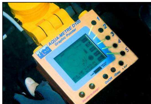
Figure 32 : Principe de télémétrie acoustique et aquamètre D100
