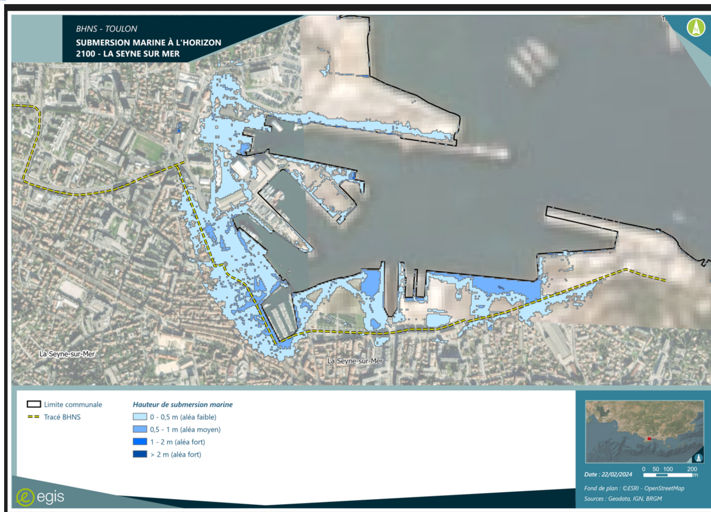
FIGURE 51 : ALEA SUBMERSION MARINE SUR LA ZONE DE LA-SEYNE-SUR-MER POUR L'ÉVÈNEMENT MOYEN 2100 – SOURCE : EGIS
