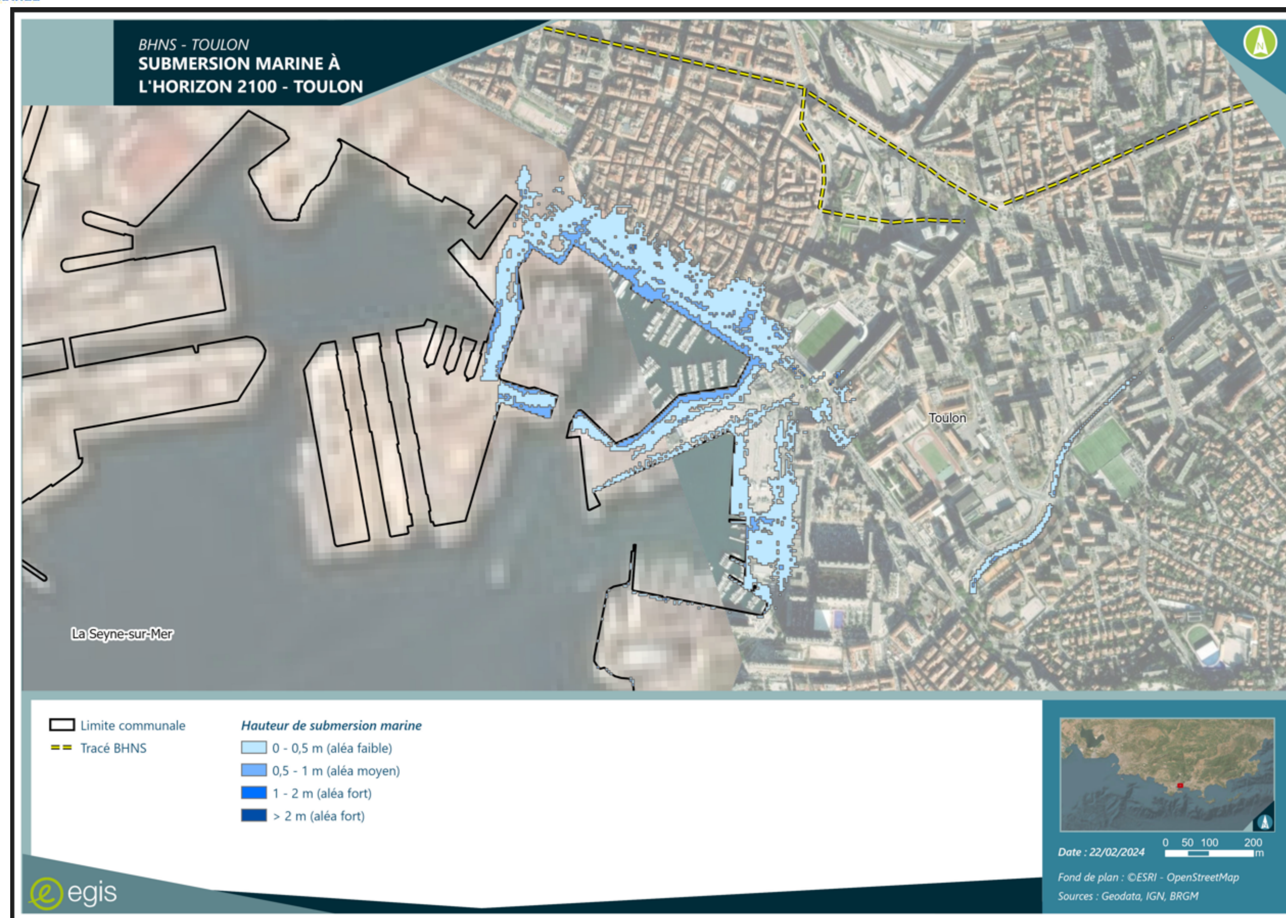
FIGURE 52: ALEA SUBMERSION MARINE SUR LA ZONE DE TOULON POUR L'ÉVÈNEMENT MOYEN 2100 – SOURCE : EGIS
