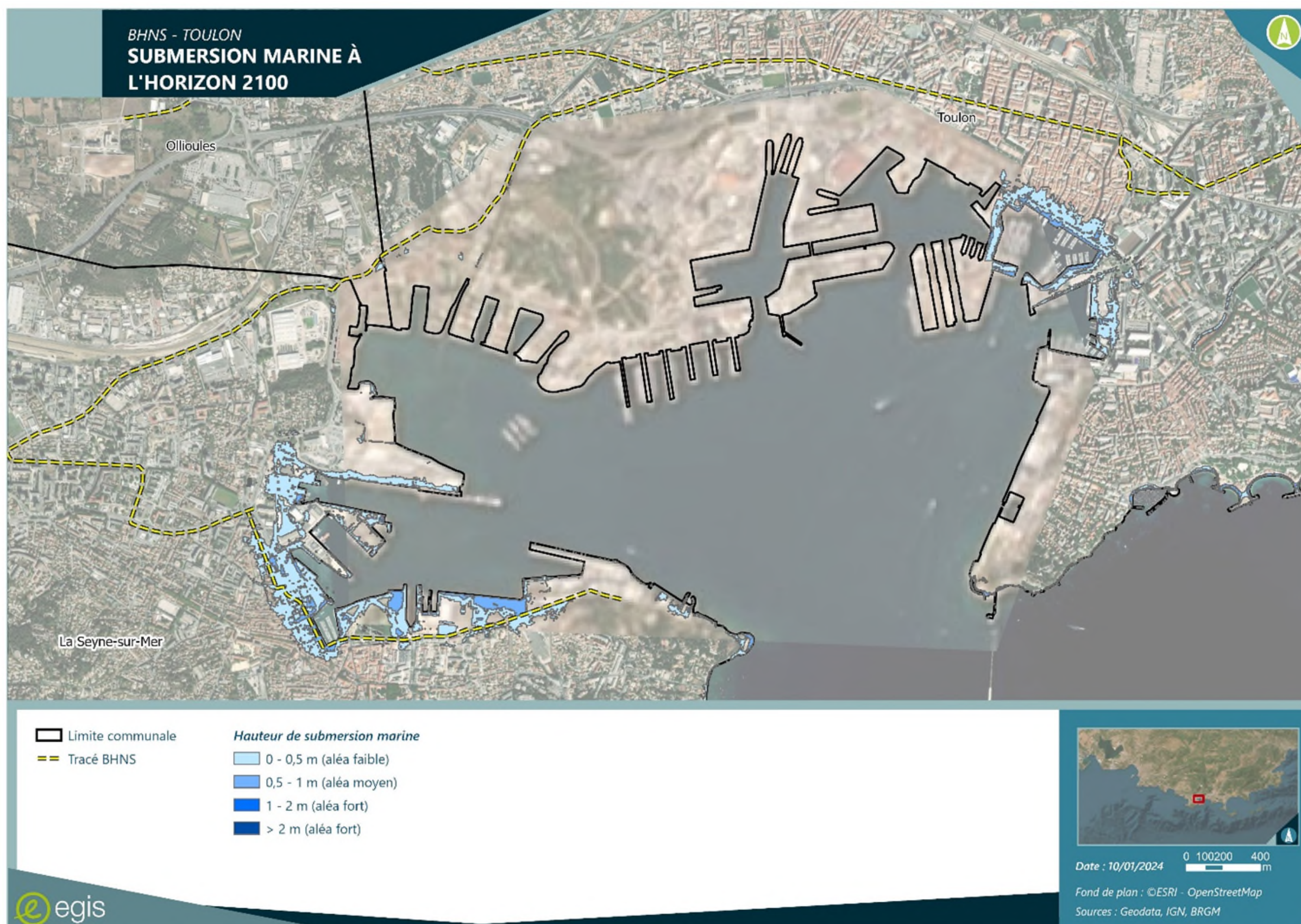
FIGURE 50 : ALEA SUBMERSION MARINE SUR LA ZONE OUEST DU PROJET POUR L'ÉVÉNEMENT MOYEN 2100 – SOURCE : EGIS
